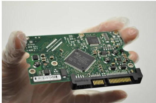
<g.PCB (制御基板) >
